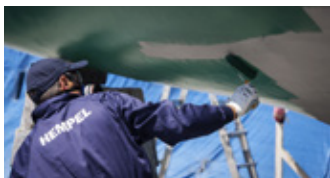
Apply antifouling over primer or tiecoat
